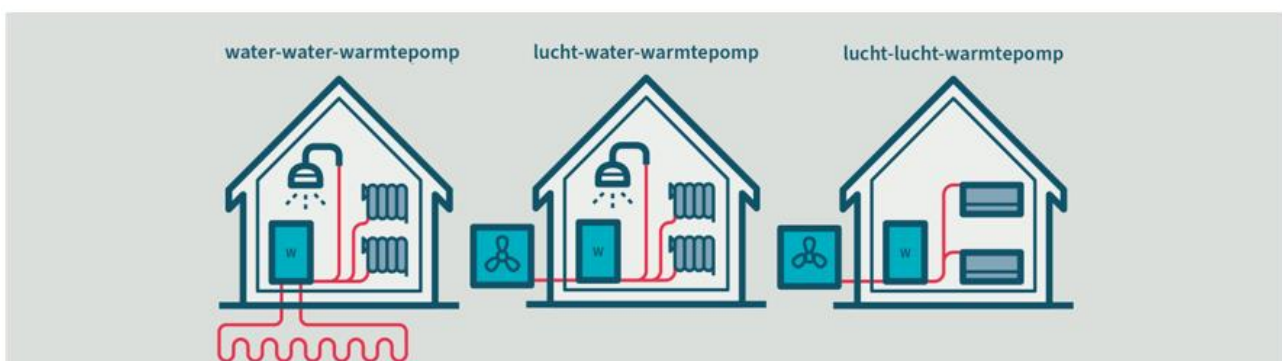
Figuur 1: Schematische weergave van verschillende individuele warmtesystemen
